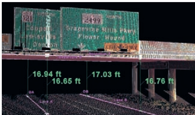
計測や注釈ツールによる跨線橋のクリアランスの解析
