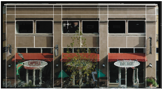
CloudWorx における典型的な点群データの使い方は、建築立面やモデルの生成のため、寸法的に正しい 2D あるいは 3D ワイヤフレームをトレースすることです。
