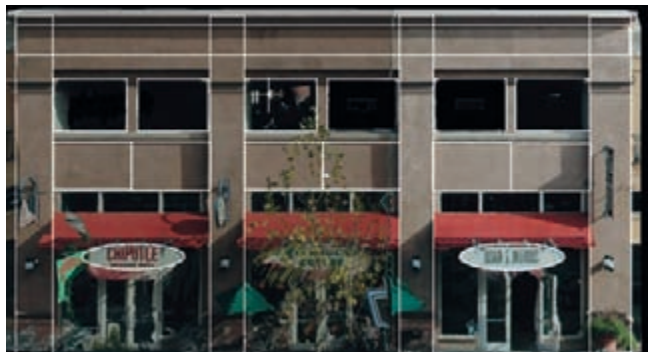
CloudWorxによりAutoCADに読み込まれた点群をトレースし、2D/3Dのワイヤーフレームを作成。
